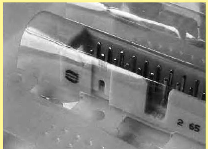
Conector SEK montado sobre una cinta listo para su colocación mediante una estación de montaje de formas irregulares.
